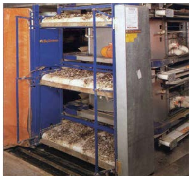
Рис. 22. Ленточная система пометоудаления
