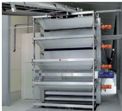
Рис. 22. Ленточная система пометоудаления
