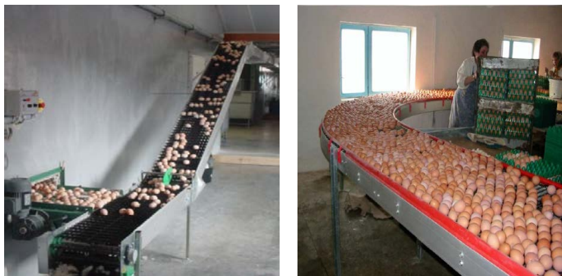
Рис. 11. Прутковые конвейеры для транспортировки яиц
