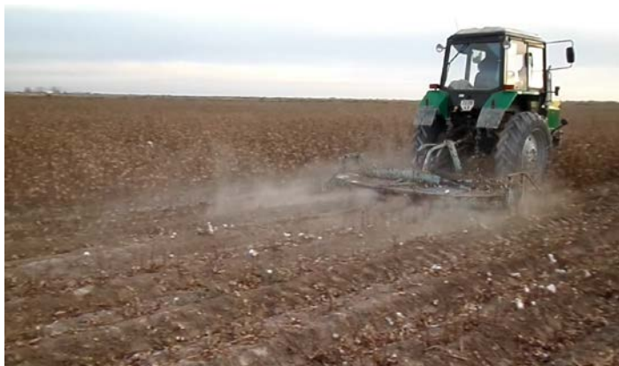
Рис. 2. ИСХ-3,6 измельчитель стеблей хлопчатника в полевых условиях
