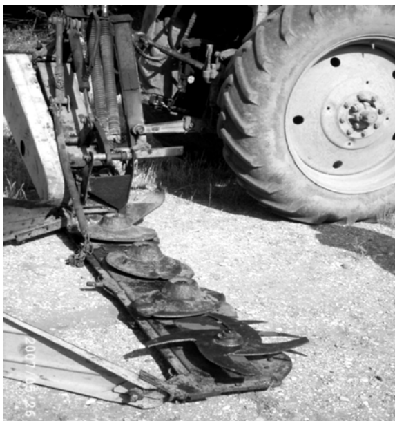
Рис. 2.37. Рабочий орган четырехроторной косилки конструкции КБГСХА
