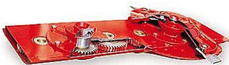
Рис. 2.17. Фрагмент режущего аппарата косилки фирмы Pottinger
