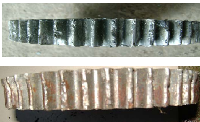
Рис. 2.94. Шестерни режущего аппарата с изношенными зубьями
