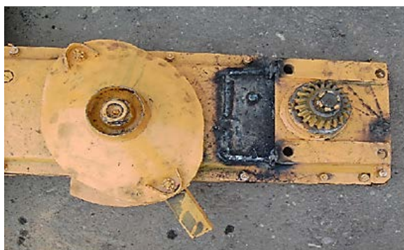
Рис. 2.93. Излом режущего бруса у первого ротора
