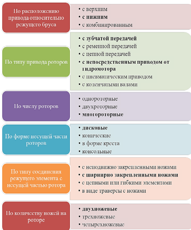
Рис. 2.4. Классификация роторных косилок с осью вращения, перпендикулярной к окашиваемой поверхности
