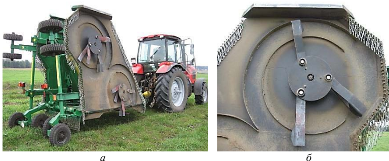
Рис. 2.67. Косилка КП-6,2: а – по шесть ножей на роторе; б – по три ножа на роторе
