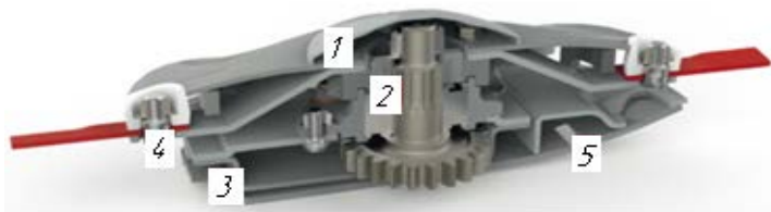
Рис. 2.35. Фрагмент режущего аппарата косилки Silvercut: 1 – специальная форма дисков обеспечивает быстрый и эффективный отвод скошенной массы; 2 – каждый диск оборудован предохранительным устройством, защищающим режущий аппарат от поломок в результате критических перегрузок диска; 3 – диски косилки дополнительно защищены в задней части режущего бруса; 4 – система быстрой замены ножей; 5 – закругленная форма башмаков скольжения обеспечивает большой поверхностный контакт
