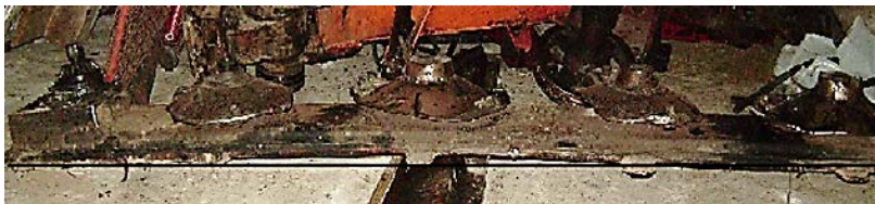
Рис. 2.91. Дугообразный изгиб бруса режущего аппарата
