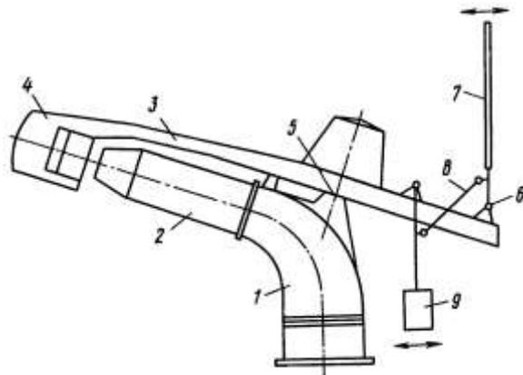
Рис. 2. Дождевальный аппарат с кинематической связью паруса-датчика и противовеса: 1 – корпус; 2 – ствол; 3 – коромысло; 4 – реактивная лопатка; 5 – ось вращения коромысла; 6 – шарнир; 7 – парус-датчик; 8 – тяга; 9 – противовес [6]
