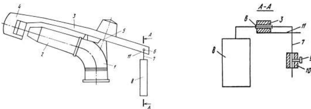
Рис. 3. Дождевальный аппарат с нижним расположением паруса-датчика: 1 – корпус; 2 – ствол; 3 – коромысло; 4 – реактивная лопатка; 5 – ось вращения коромысла; 6 – шарнир; 7 – изогнутая ось; 8 – парус-датчик; 9 – фиксирующий винт; 10 – противовес; 11 – ограничитель [7]
